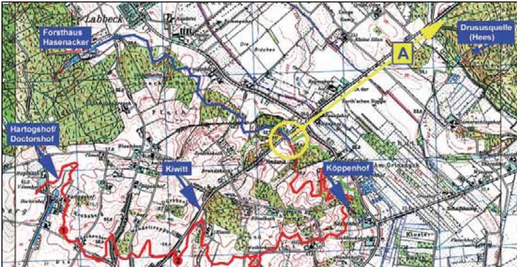
Abb. 44: Die Erschließungsmöglichkeit weiterer Quellgebiete (blaue Pfeile), die möglichen Trassen von dort (rote und grüne Linie), ihre Zusammenführung an einer Stelle (gelber Kreis) und der Trassenverlauf über die Furth hinweg zur CUT (gelber Pfeil; darin Markierung A: nachgewiesener Aquäduktabschnitt, vgl. Abb. 49) (nach: Topographische Karte 1:25000, Blatt 4304, Xanten, Landesvermessungsamt Nordrhein Westfalen).
